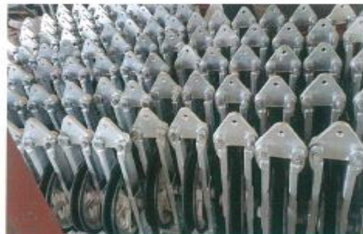
รอกพาดสาย 115 KV 1 ร่อง
