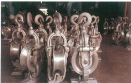
รอกพาดสายระบบ 22-33 KV 185 Sq.mm.
