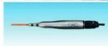
เลขที่สั่ง / Order no. : UR-50 ระยะวิ่ง / Stroke (mm) : 0.5 ความเร็วรอบ / Speed (stroke/min) : 45,000 น้ำหนัก / Weight (g) : 220 ขนาด / Dimensions (mm) : Ø 23x185L
